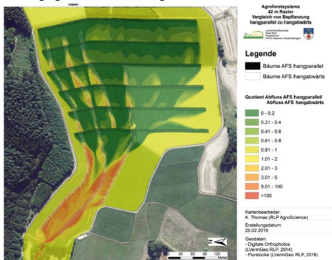
Abb. 1: Vergleich der Abflussrate zwischen hangarallel und hangabwärts gepflanzten Agrarholzstreifen.
