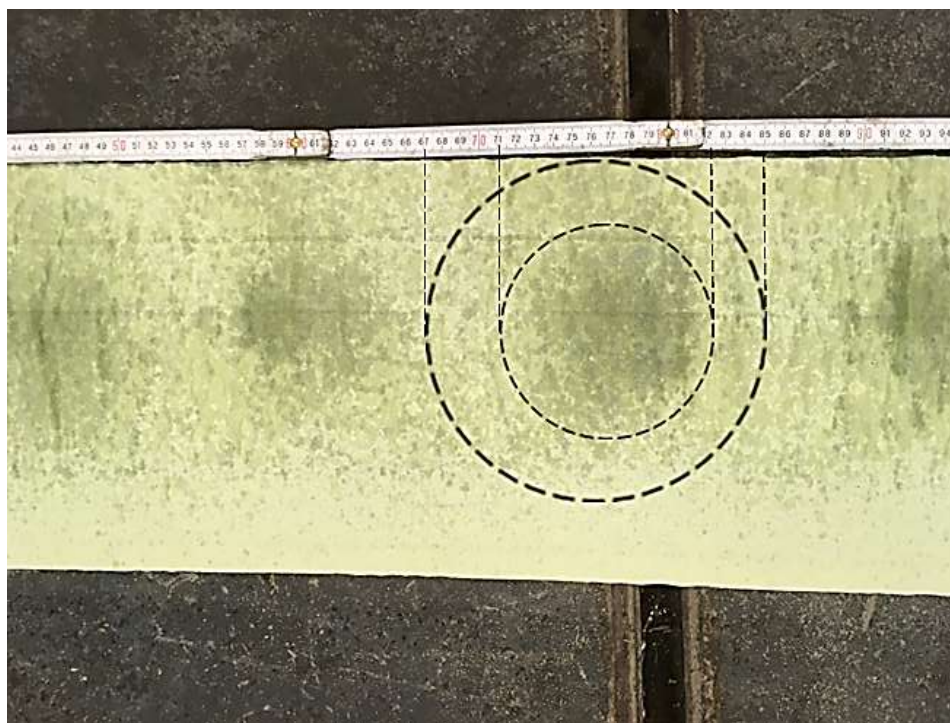
Abbildung 35 Spritzfläche von Düse mit 15° Spritzwinkel (Spritzhöhe 47,2 cm)
