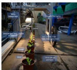
Der Versuchsaufbau für die Tests mit der Kombination Sensor und Applikationsmethode für Einzelplantzenerkennung. Unter dem Licht fließen Pflanzen auf einem Förderband, bis sie eine Applikation während der Spritzung zu sehen. © D. Lenzen
