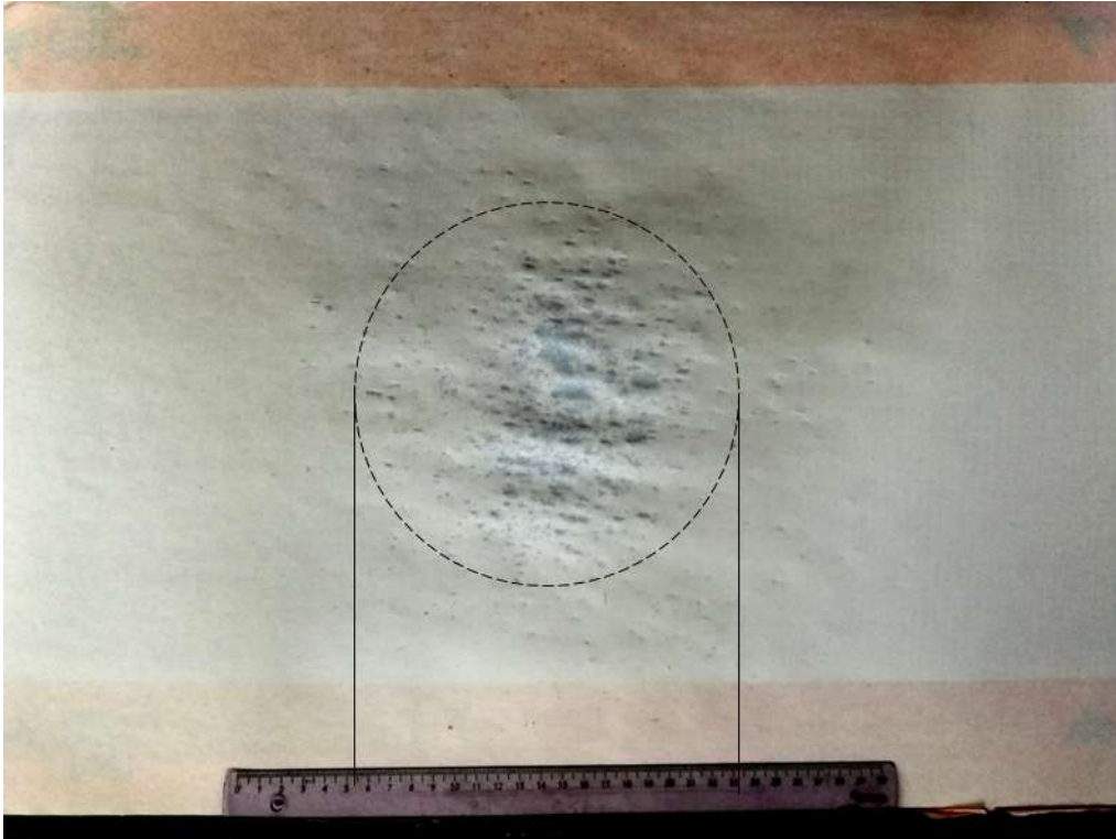
Abbildung 65 Lechler 49040330CA000 Vollkegel Düse-5 (Spritzhöhe 47,2 cm)
