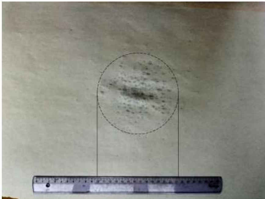
Abbildung 71 Lechler 49040330CA000 Vollkegel Düse-6 (Spritzhöhe 47,2 cm)
