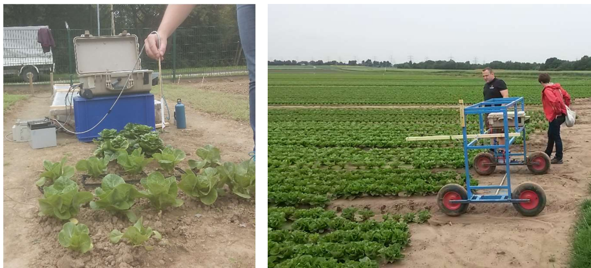
Abbildung B4: Links: Messungen mit dem Hyperspektralsensor im Garten des FZJ unter semi-kontrollierten Bedingungen. Rechts: das „Fieldbike“ für Feldmessungen beim Praxisbetrieb..
