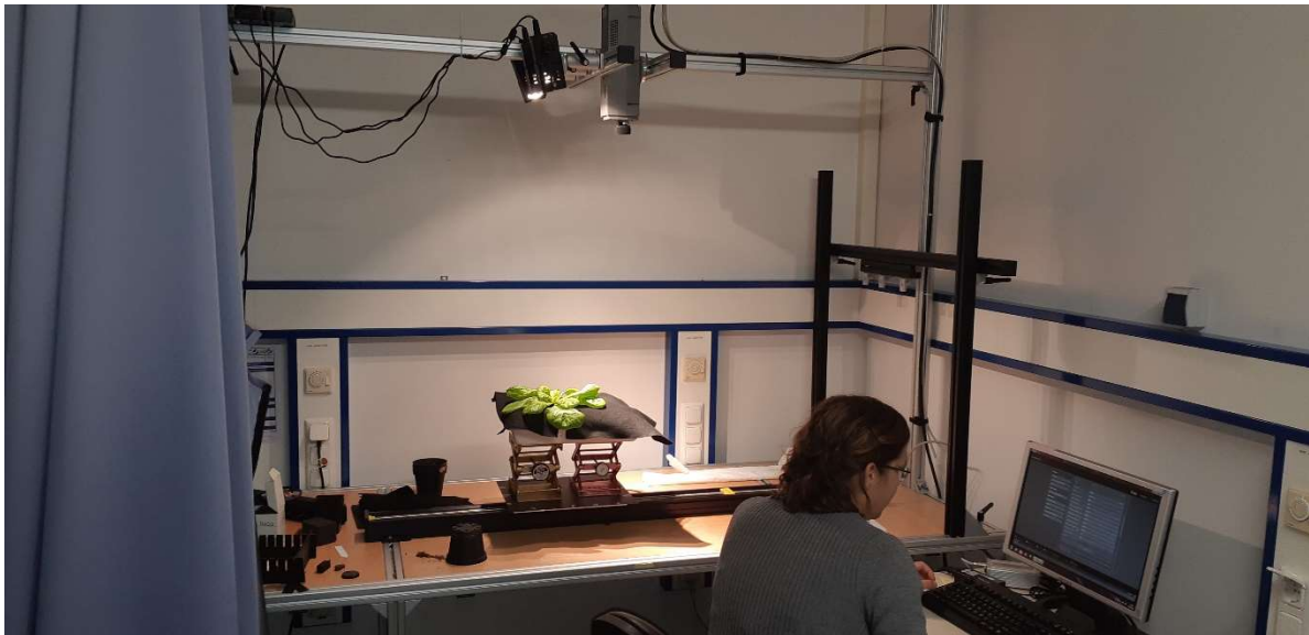
Abbildung B3: Versuchsaufbau zum Messen der hyperspektralen Reflektanz unter kontrollierten Bedingungen am FZJ.
