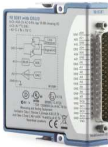
Abbildung 13 Multifunktionsmodul als Schnittstelle (SPS & Sensoren Aktoren)
