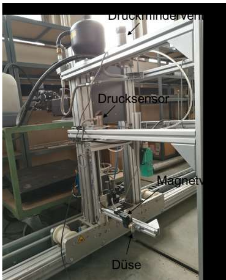
Abbildung 6 Hydrauliksystem des Versuchstands
