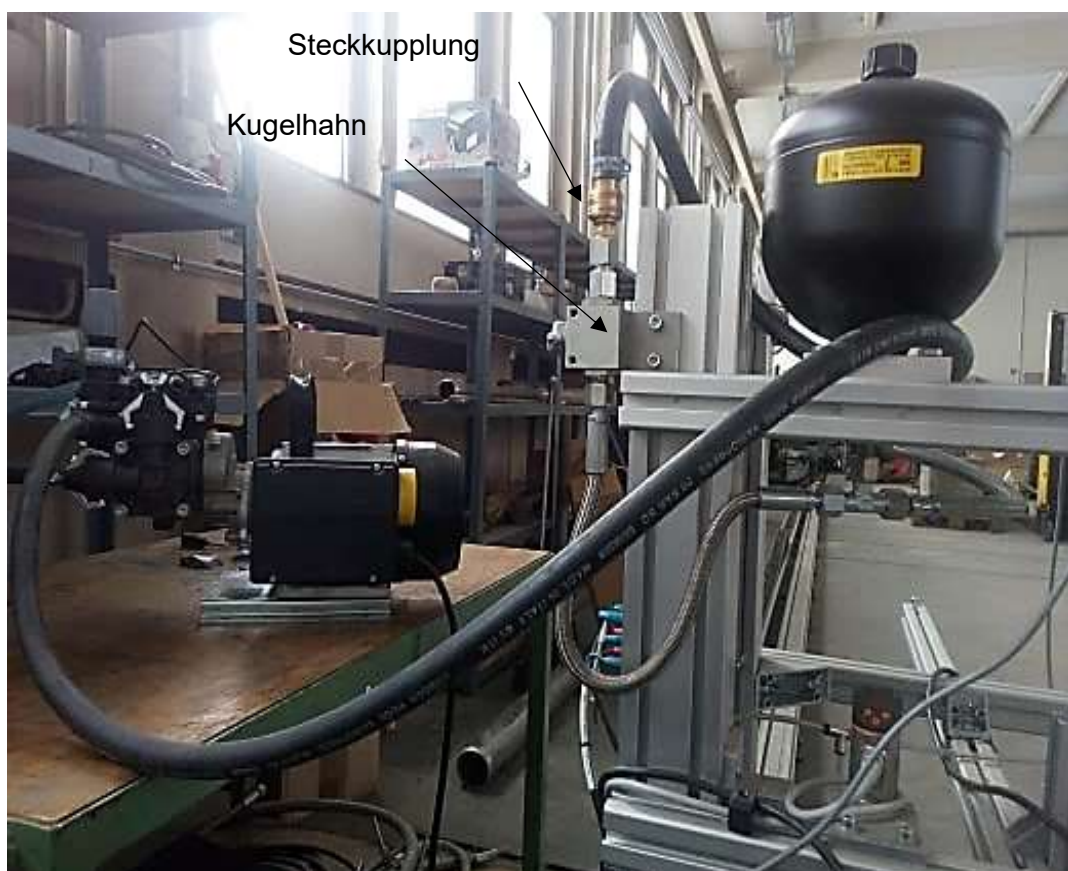
Abbildung 5 Verbindungselemente des Hydrauliksystems
